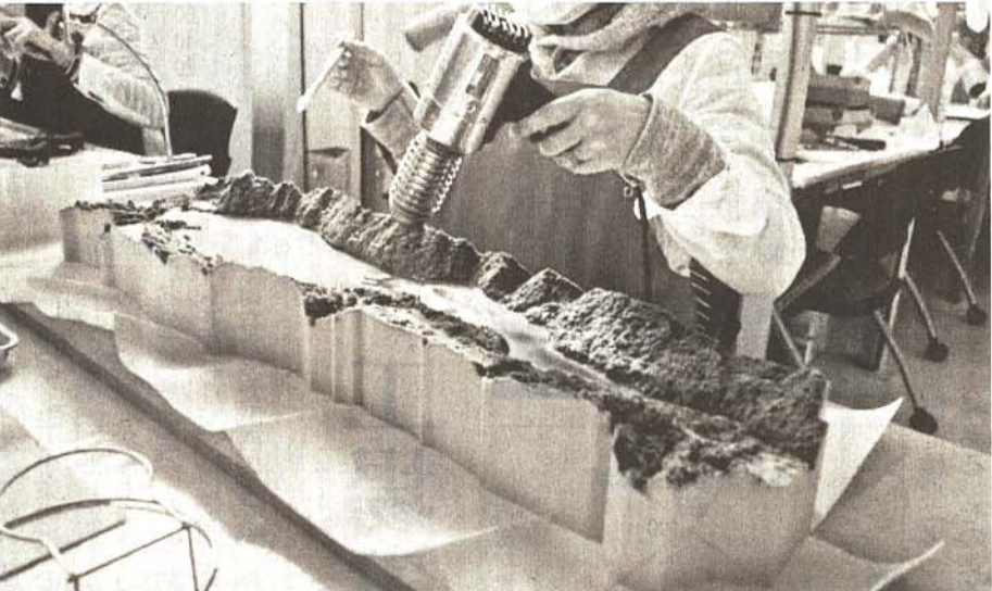
写真上は3Dプリンターで造形するために作られた3Dデータ。造形時はこの3Dモデルを半分に分割した(資料 ハヤテ・コンサルタント)。写真下は表面をパラフィンワックスでコーティングする作業(写真 アイジェクト)
